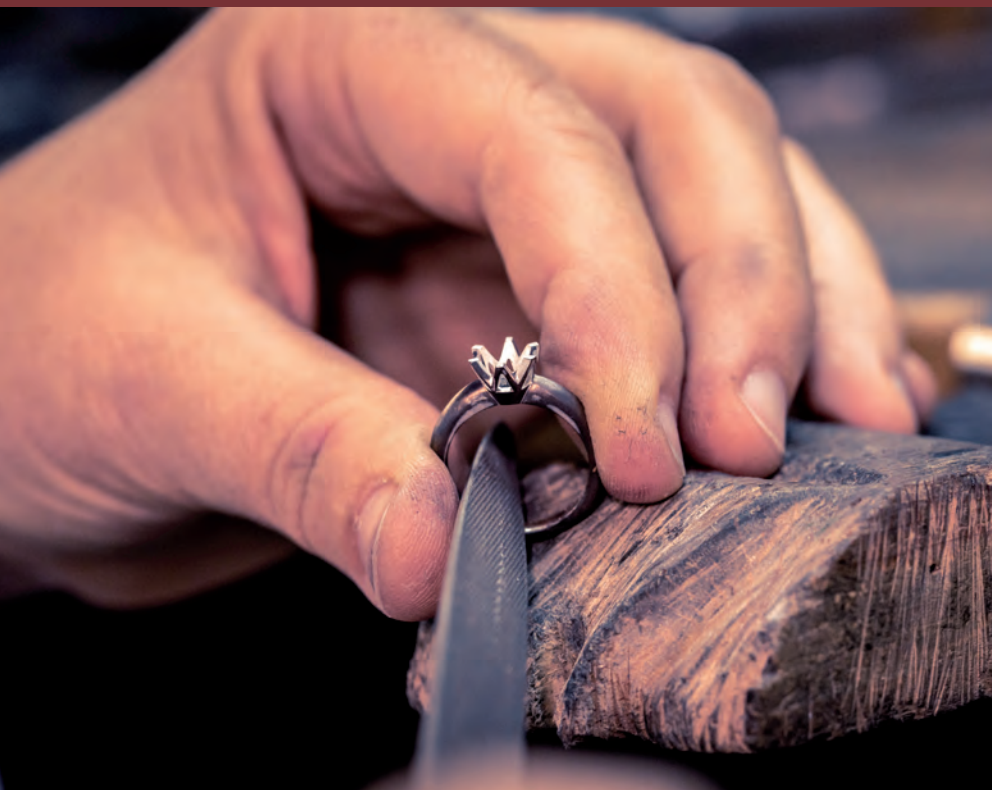
Kräftige Muskeln sind erforderlich, um das Werkstück mit der Hand zu fixieren und die Feile exakt zu führen.
