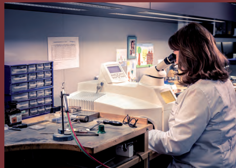
Mit dem Laserschweißgerät kommt in unserem Atelier modernste Technik zum Einsatz.
