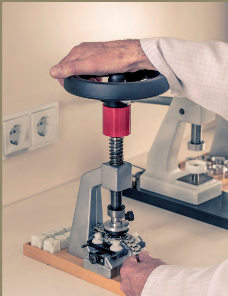
Nur mit einem passgenauen Spezialwerkzeug lässt sich eine Uhr „spurlos“, also ohne Kratzer und Beschädigungen, öffnen.
