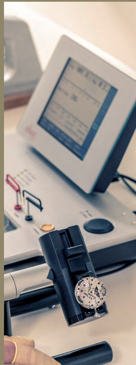
Mit dem Zeitprüfgerät wird die Uhr reguliert. Es wird eingestellt wie schnell die Uhr „laufen“ soll, damit sie exakt auf der Zeit bleibt.
