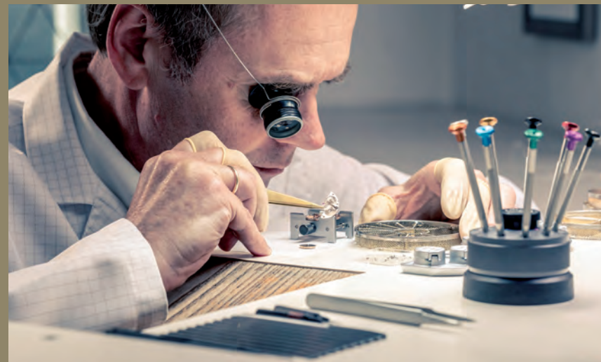
Der Uhrmacher prüft jedes einzelne Teil mit Lupe oder Mikroskop auf Verschleiß und entscheidet über Verbleib oder Austausch.
