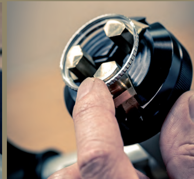
Das Schleifen einer Lünette eines Breitling Navitimers erfordert Erfahrung und Fingerspitzengefühl.
