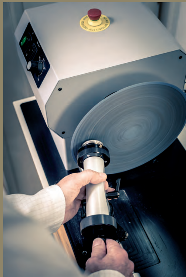
An der Lapidiermaschine werden die einzelnen Facetten exakt händisch nachgeschliffen.
