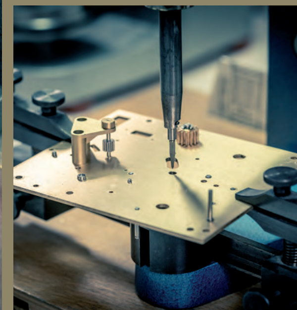
Die zu groß gewordenen Lager werden zentrisch ausgebohrt und erneuert.
