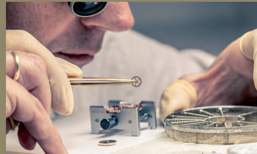
Dieses Zahnrad, ein „Kleinbodenrad“, hat an den Zapfen leichte Abriebspuren und muss daher getauscht werden.
