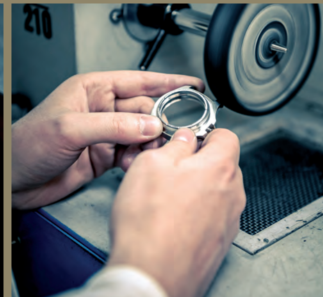
Das Finish: Mit der Poliermaschine bringt man die Einzelteile schlussendlich zum Glänzen.
