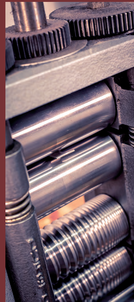
Mit der Walze wird mit großem Druck ein „Blech“ gewalzt.
