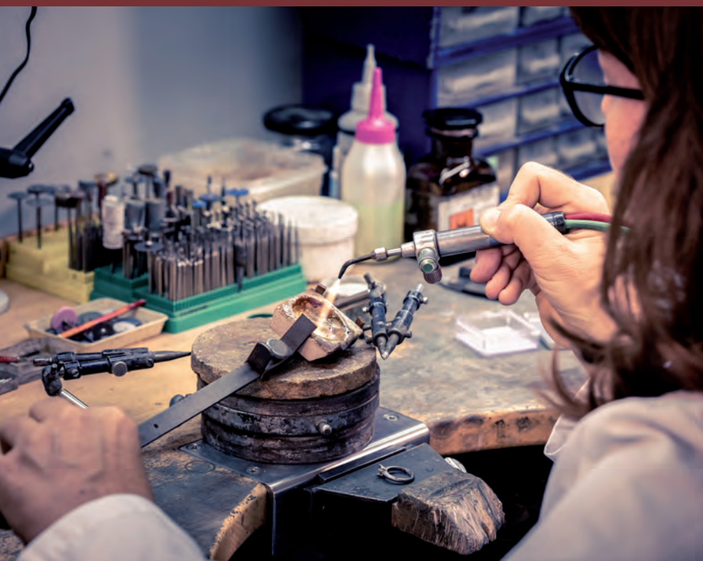
Beim Legieren wird das reine Gold mit anderen Metallen vermengt, um den richtigen Feingehalt und die richtige Farbe zu erhalten.
