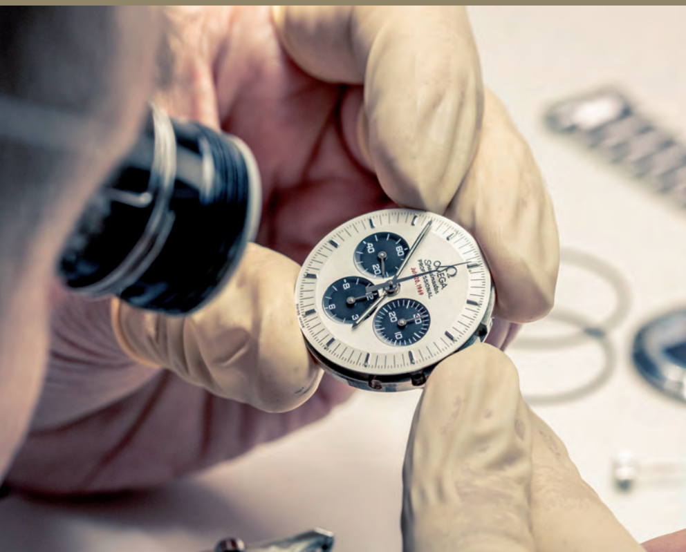
Nach dem Aufsetzen der Zeiger erfolgt der Einbau des Uhrwerks in das Gehäuse.
