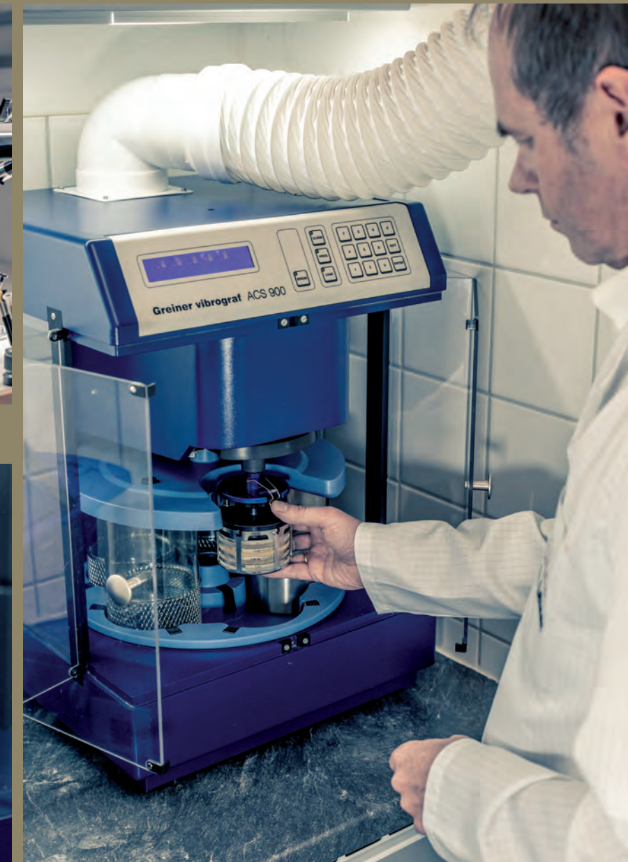
Die Gitterkörbe kommen in die Reinigungsmaschine, wo sie eine knappe Stunde „gewaschen“ werden.
