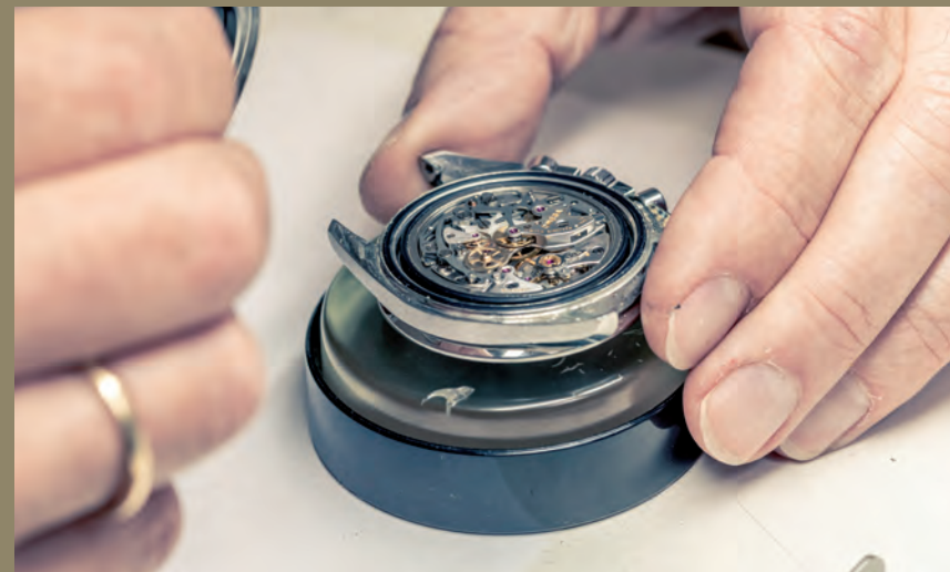
Die soeben geöffnete Uhr. Hier bekommt der Uhrmacher einen ersten Eindruck.
