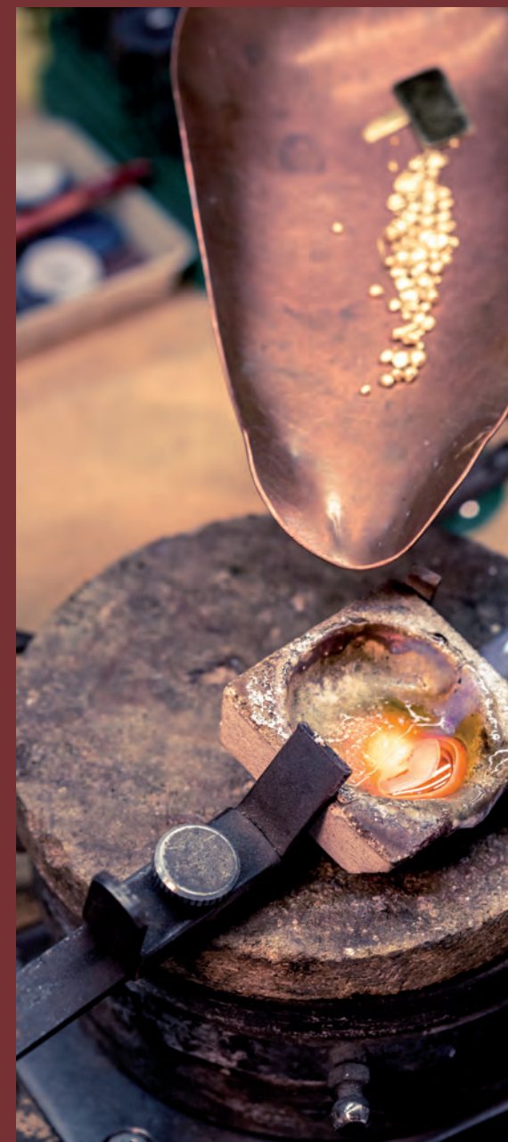
Das reine Feingold wird in Form von Granulat im Schmelztiegel geschmolzen. Dazu muss es auf über 1000 Grad erhitzt werden.
