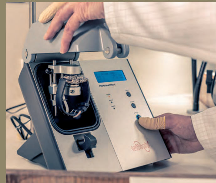
Mit dem Wasserdichtheitsprüfgerät wird die Uhr mittels Unter- und Überdruck auf Dichtheit geprüft.
